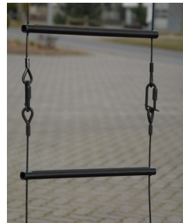
Bild 7: Anreihung einer zweiten Seileiter.
