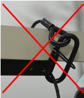
Bild 5: Biege- oder Knickbelastung der Schnellverbindungsglieder und der Verpressungen mit Kauschen vermeiden werden.
