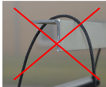
Bild 4: Drahtseil der Seilleiter nicht über scharfe Kanten führen.
