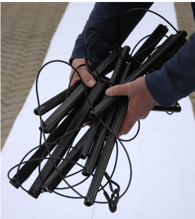
Bild 15, 16, 17: Alle Sprossen zusammenführen und in den geöffneten Sack legen, zuziehen, fertig.
