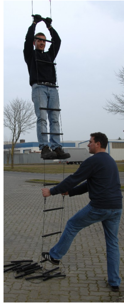
Bild 2: Seilleiter gegen Pendeln gesichert.
